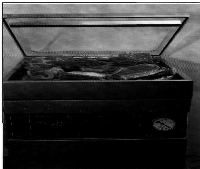
Рис. 2.4. Вакуум-упаковочная машина «заказ 119 А ОАО «Кварц» 1993 года»
