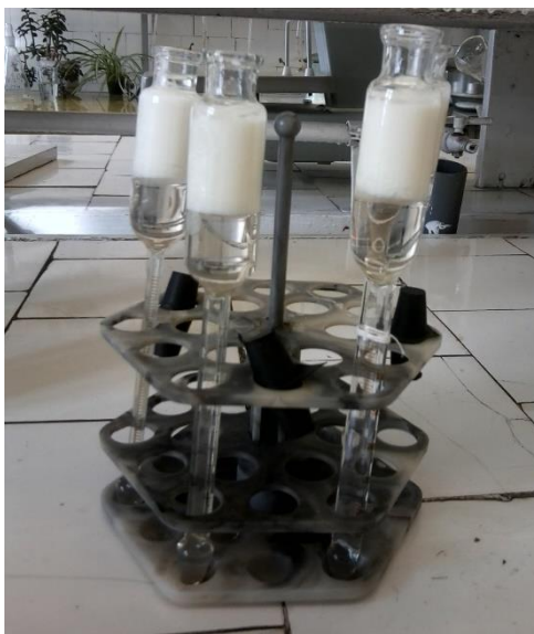
Рисунок 1.1 – Жиромеры с пробой молока после добавления реактивов
