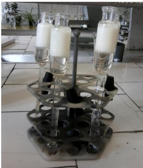
Рисунок 1.1 – Жиромеры с пробой молока после добавления реактивов
