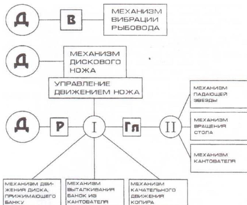
Рис. 6.1. Структурная схема машины ИНА-115
