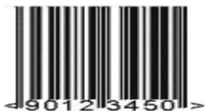
Рисунок 4.4 – Пример кода линейной символики EAN-8
