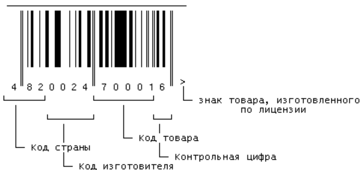
Рисунок 4.3 – Пример расшифровки штрих-кода EAN-13
