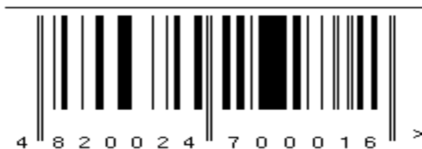
Рисунок 4.1 – Пример кода линейной символики EAN-13
