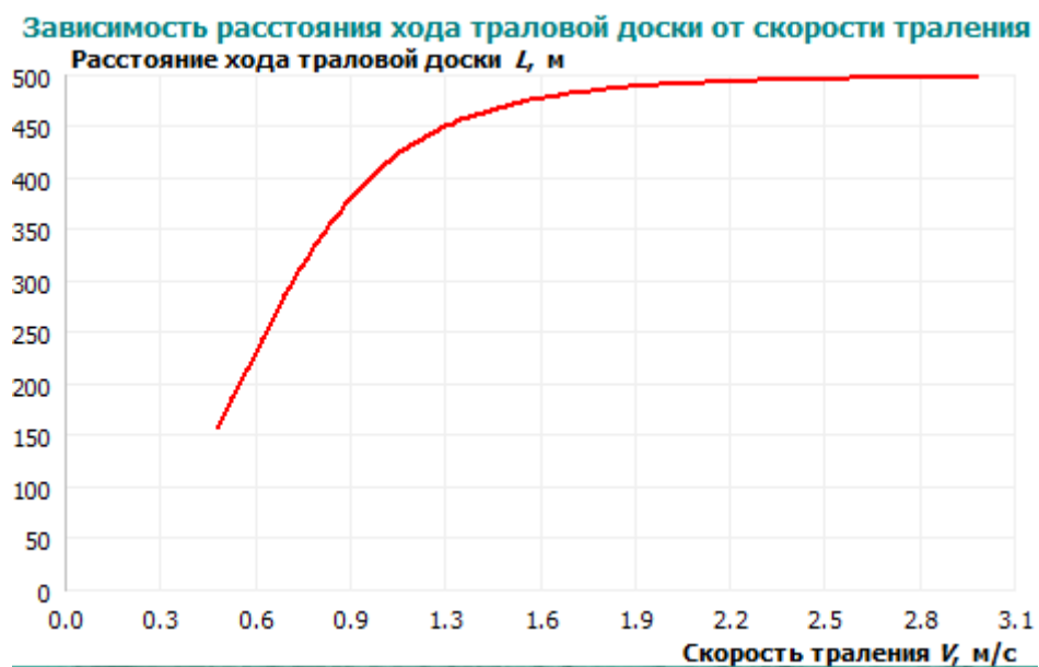
Рис. 17. Зависимости расстояния хода траловой доски по горизонту от длины ваера и скорости траления
