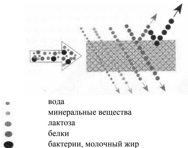
Рисунок 1.7 – Принцип разделения молекул при микрофильтрации
