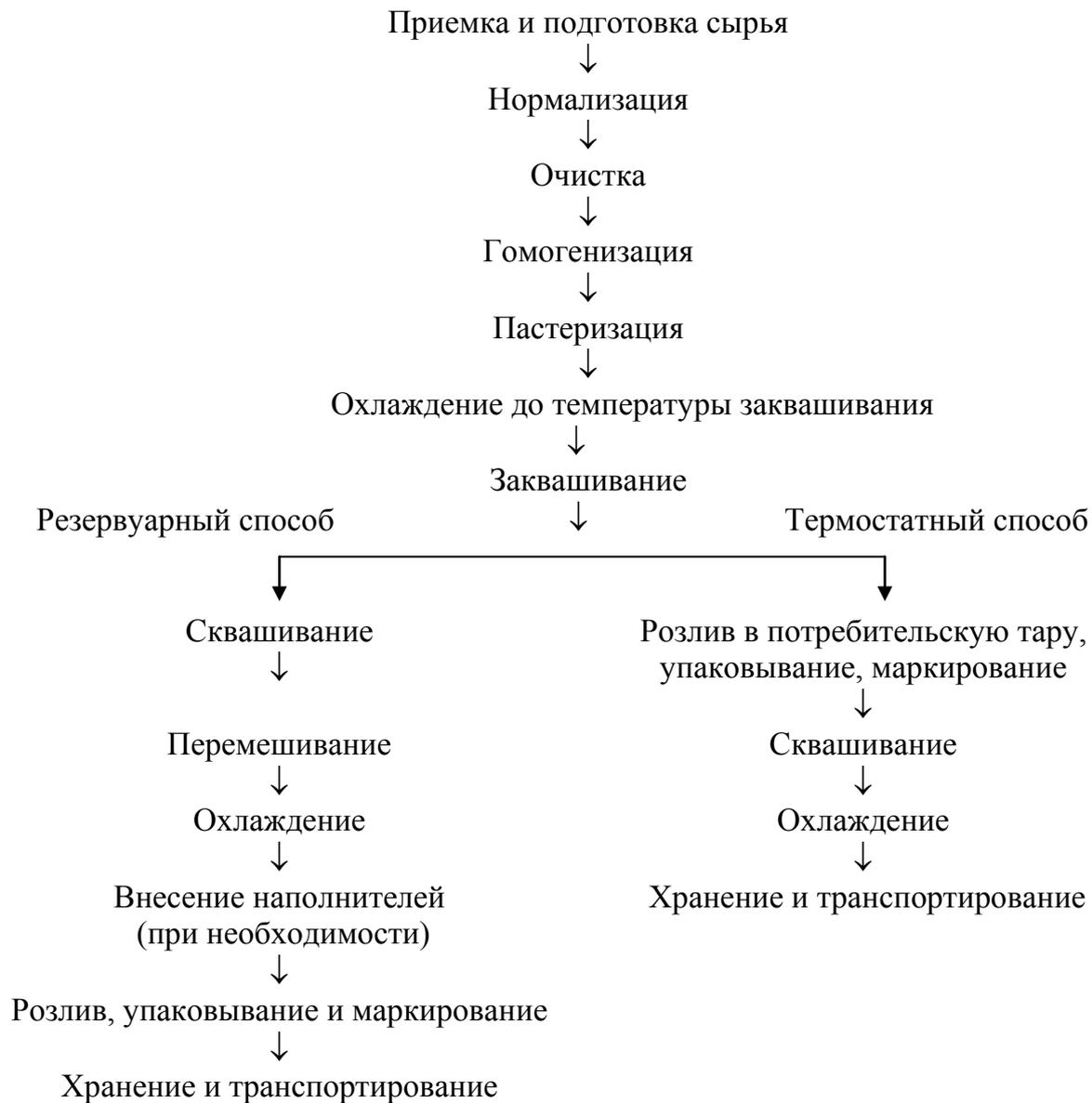
Рисунок 3.2 – Технологическая схема производства кисломолочных напитков
