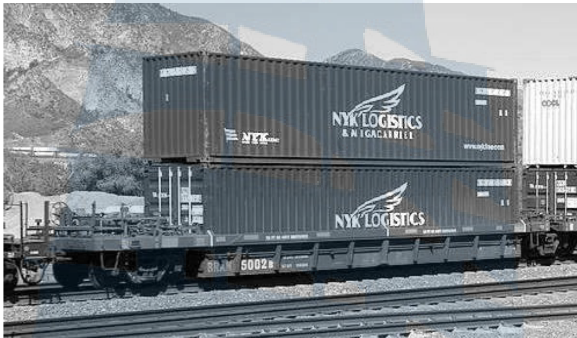
Рис. 44. Железнодорожная двухъярусная платформа
