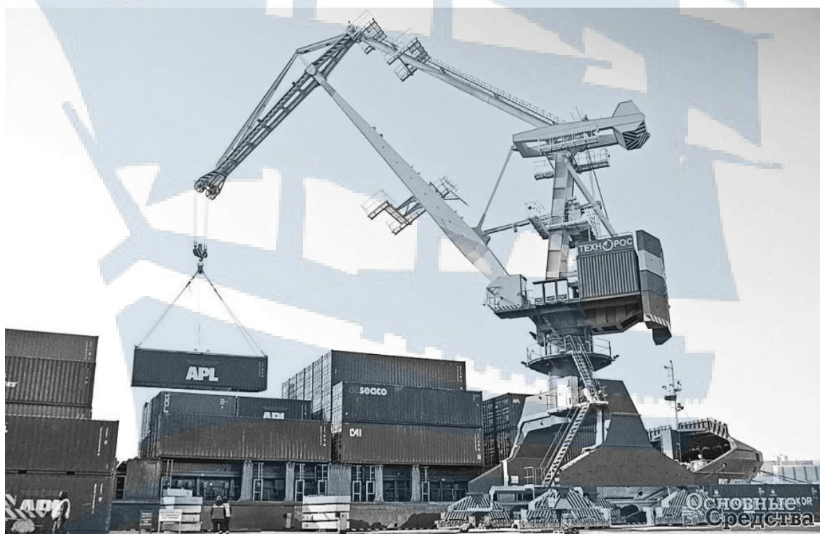
Рис. 95. Портальный кран для перегрузки контейнеров
