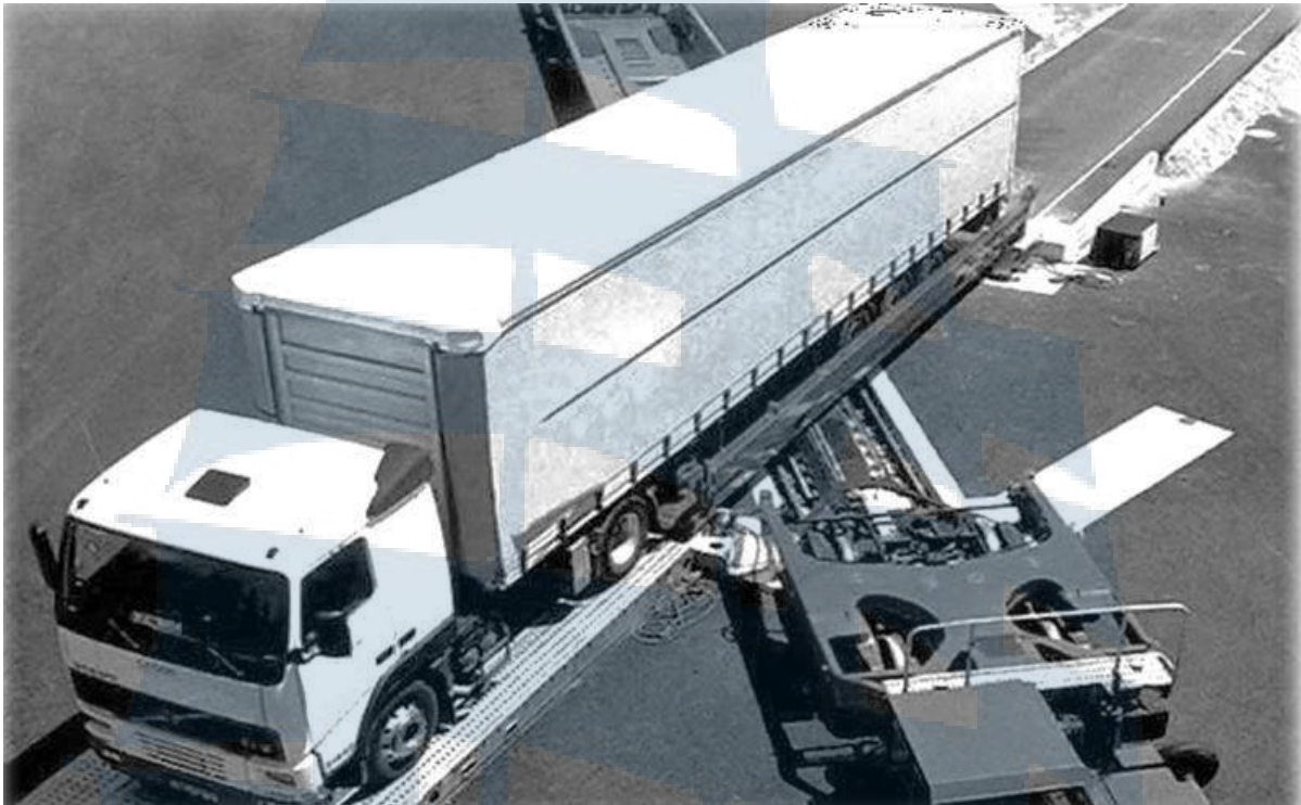
Рис. 31. Погрузка контрейлера на платформу по технологии Modalohr
