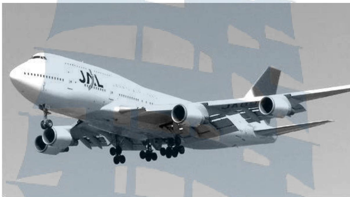
Рис. 147. Широкофюзеляжный дальнемагистральный самолёт В-747
