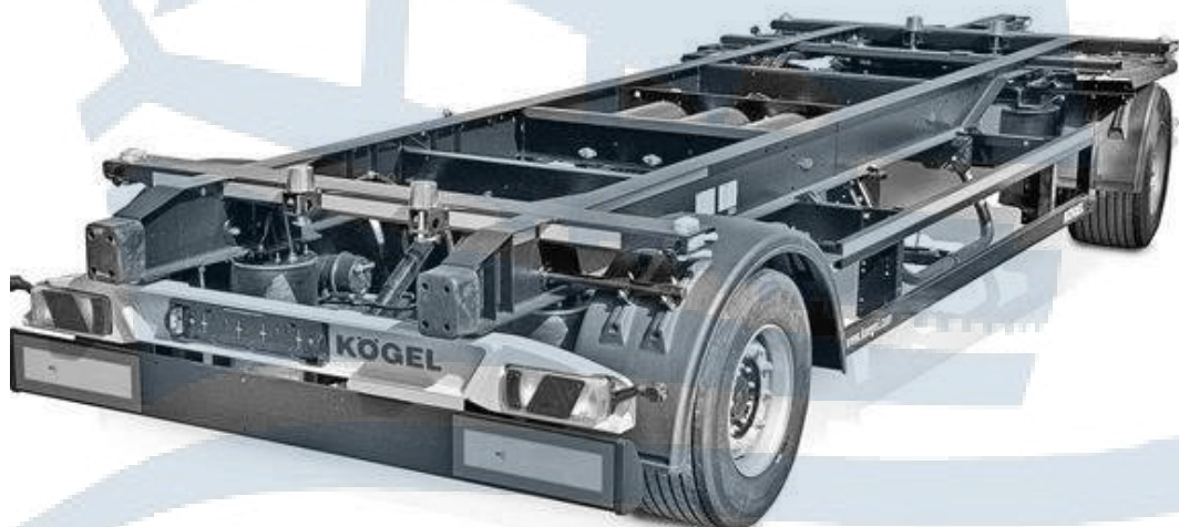
Рис. 10. Прицеп Kögel Combi с разнесенными осями
