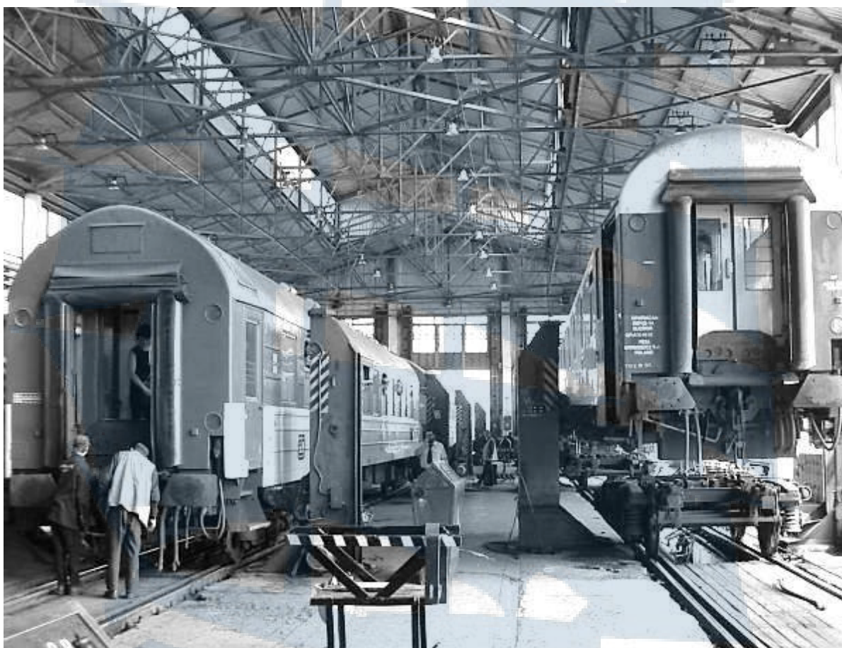
Рис. 53. Перестановка тележек у вагонов
