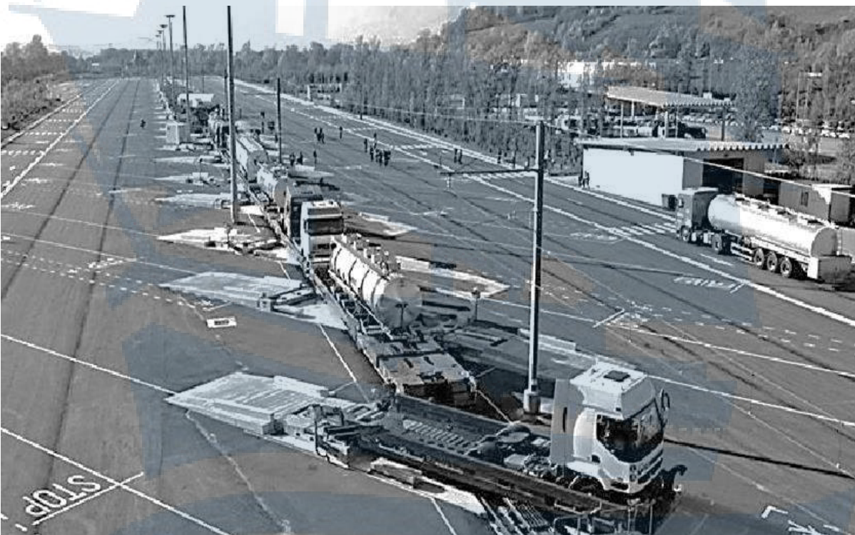
Рис. 32. Погрузка контрейлеров на терминале Modalohr
