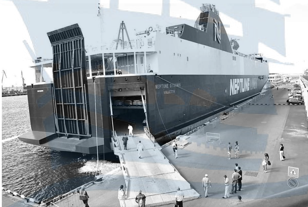
Рис. 135. Паром с кормовой и угловой рампой
