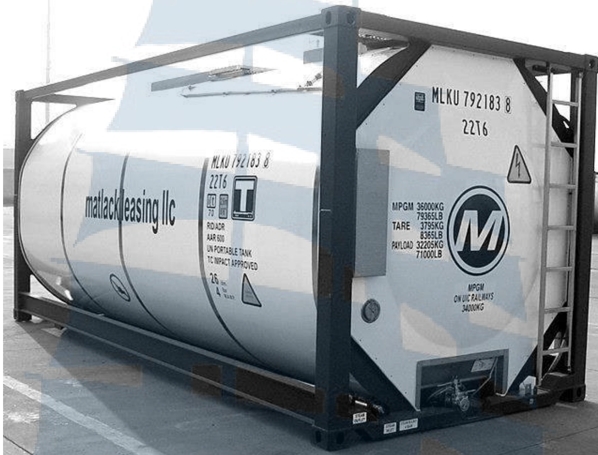
Рис. 65. 20-футовый танк-контейнер TD (Tank container)
