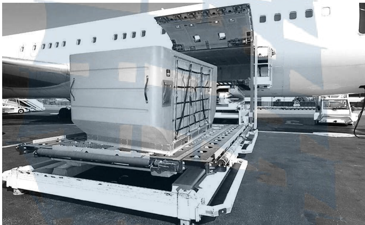
Рис. 150. Загрузка СПГ (контейнер) в самолет
