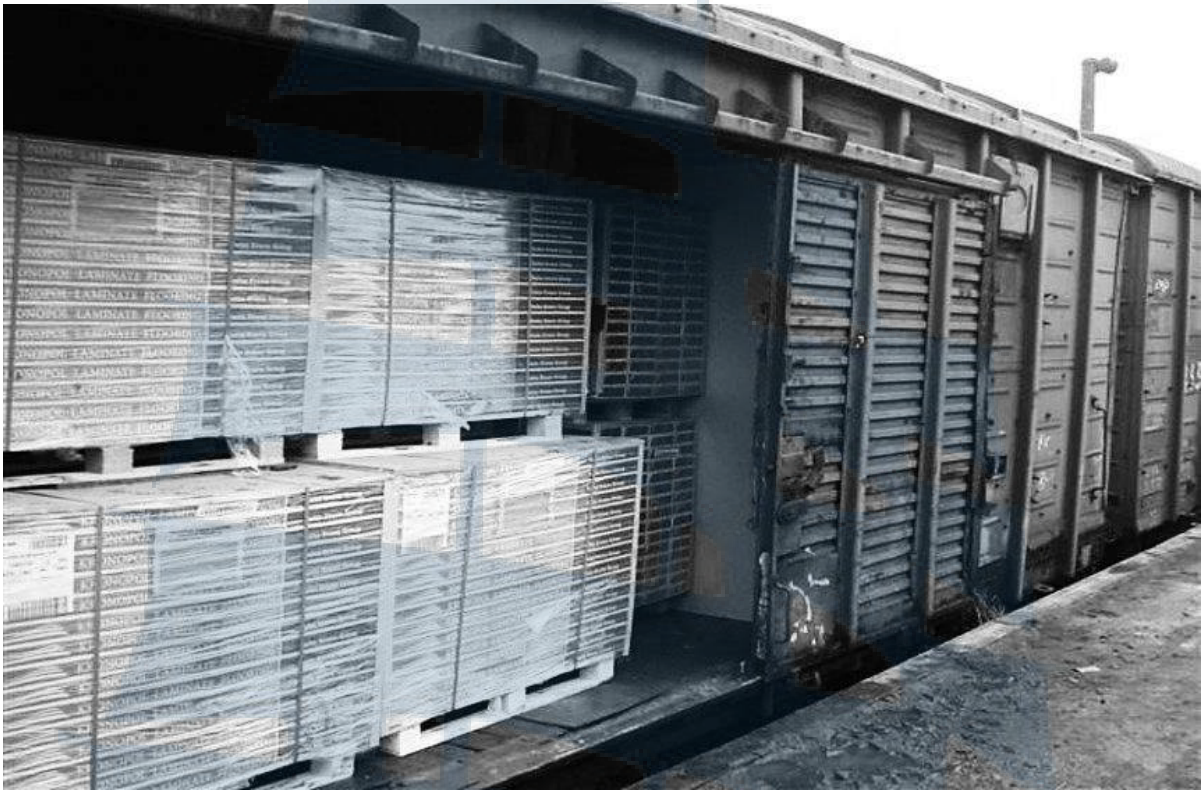
Рис. 160. Размещение пакетов в вагоне
