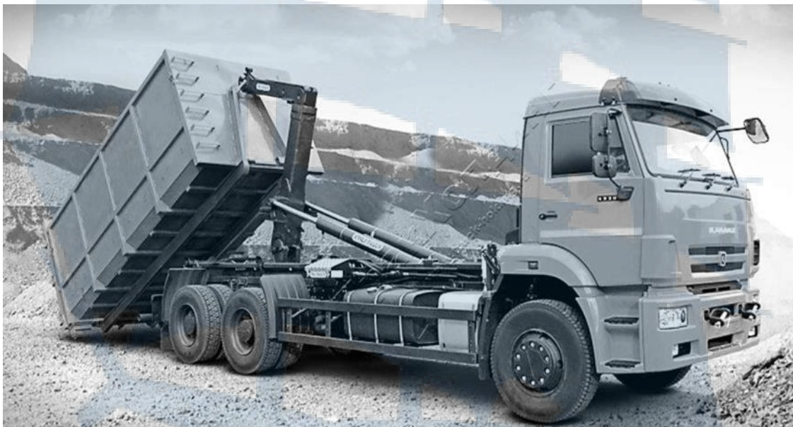
Рис. 7. Погрузка съемного кузова на тягач системой «мультилифт»
