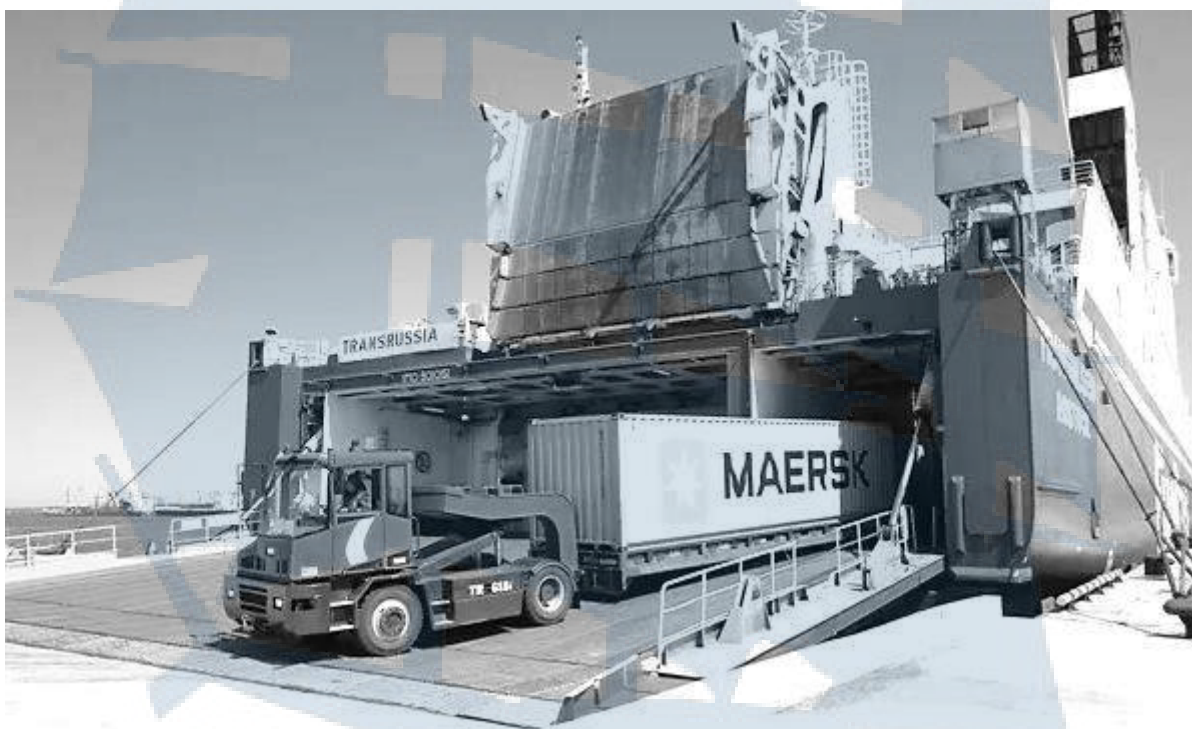
Рис. 24. Выгрузка ролл-трейлера с контейнером из судна Ро-Ро
