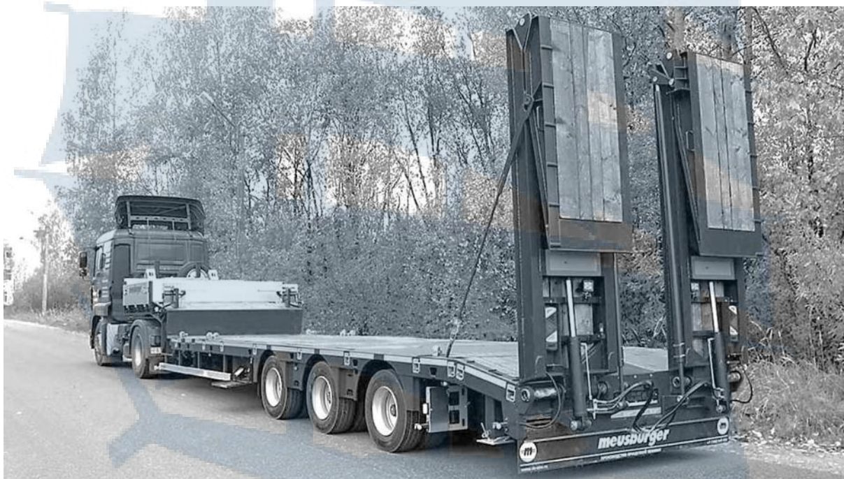
Рис. 18. Трейлер с откидными гидравлическими трапами
