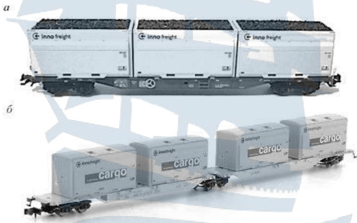
Рис. 15. Съёмные кузова компании "Innofreight": а – вагон-платформа со съёмным кузовом открытого типа; б – вагон-платформа со съёмным кузовом закрытого типа
