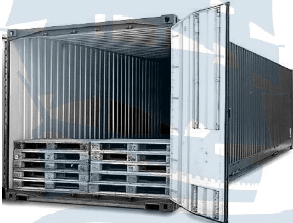
Рис. 60. 40-футовый контейнер PW (Pallet Wide) типа 1AAA
