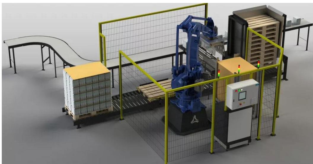
Рис. 7. Общий вид мехатронного участка паллетизации мешков с мукой массой до 50 кг
