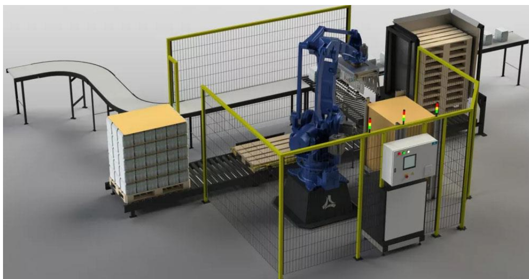
Рис. 6. Общий вид мехатронного участка паллетизации паков с водой 0,5 л и 1,5 л массой до 30 кг
